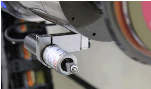
Vor Beginn der Bearbeitung erfasst der Taster die exakte Position des Werkstücks und kontrolliert abschließend noch in der gleichen Aufspannung die wesentlichen Funktionsmaße (Foto: Klaus Vollrath)
