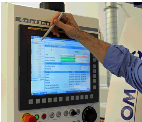
Die Steuerung lässt sich mit Hilfe eines Taststifts einfach und schnell programmieren (Foto: Klaus Vollrath)
