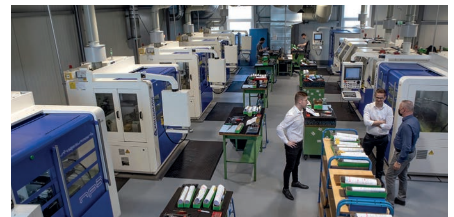
In der „Rollomatic-Ecke“ bei Premex entstehen Halbzeuge in den Durchmessern von 0,5mm bis 25mm
