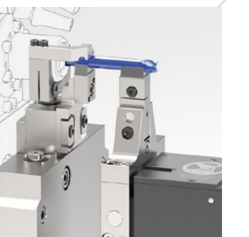
4. Lunetta d'appoggio durante scanalatura
